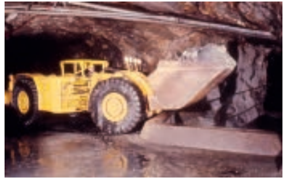
Kuva 4: 1960-luvulla saatiin todellinen kaivoskuormaaja, joka muutti kokonaan kaivostyön suunnittelun ja sen toteutuksen. Nivelohjatus Wagner-lastauskoneet korvasivat louhintalastauksessa ja louhinta-alueiden kuljetuksessa aiemmin käytetyn kaluston.
