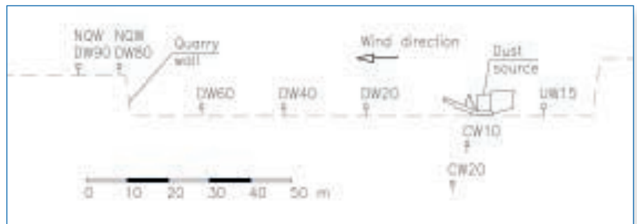
Kuva 2. Periaatekuva mittausasetelmasta. Mittauspisteiden tuulen suunnat DW = myötätuuli, CW = sivutuuli ja UW = vastatuuli.
