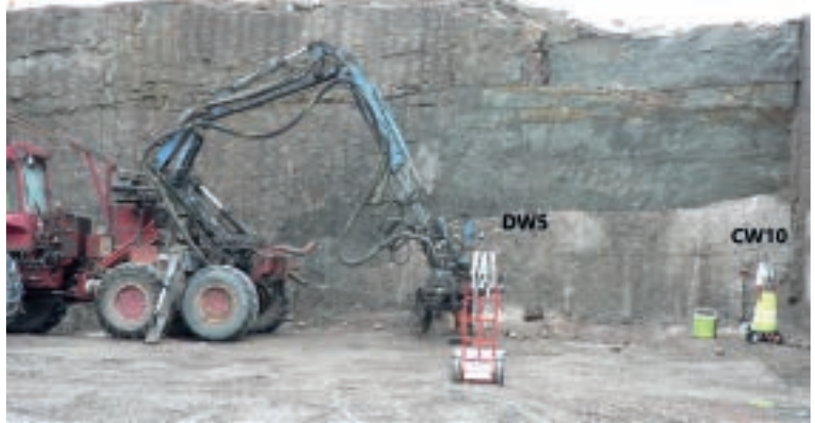
Kuva 3. Vaakaporauksen pölymittaus luonnonkivilouhimolla. Mittaus myötätuuleen 5 m etäisyydellä (DW5) sekä sivutuuleen 10 m etäisyydellä (CW10).
