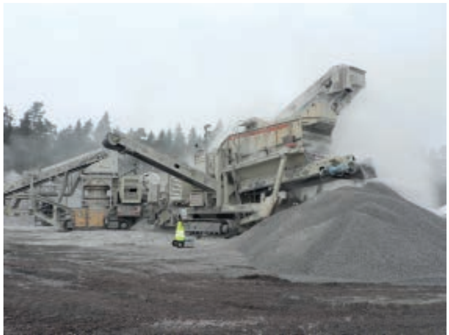
Kuva 4. Tertiäärinen murskauslaitoksen (kolme murskaussyksikköä) pölymittaus vastatuuleen.
