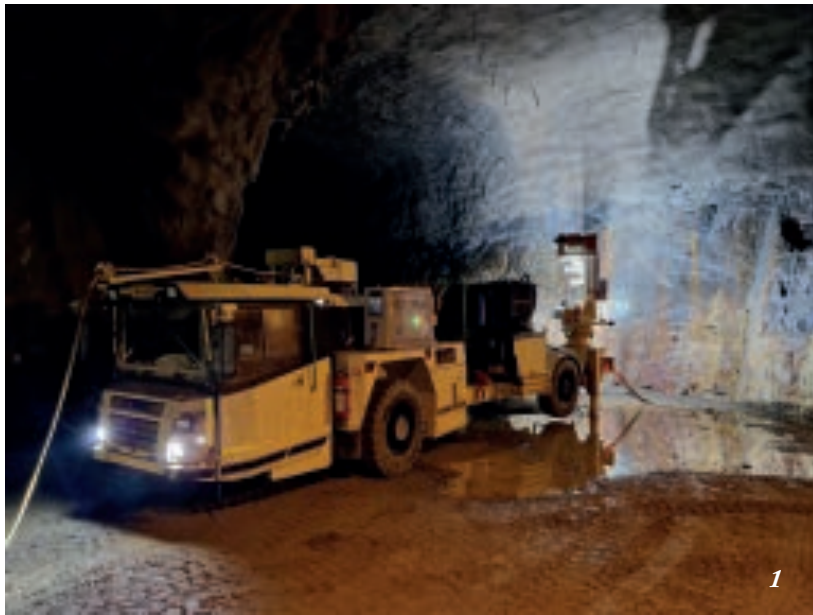
Kuva 1: Charmec Revo on Normetin uusi teknologia, jonka päämääränä on parantaa maanalaisen työskentelyn turvallisuutta merkittävästi. Kuva Callio Pyhäjärven testikaivokselta.
