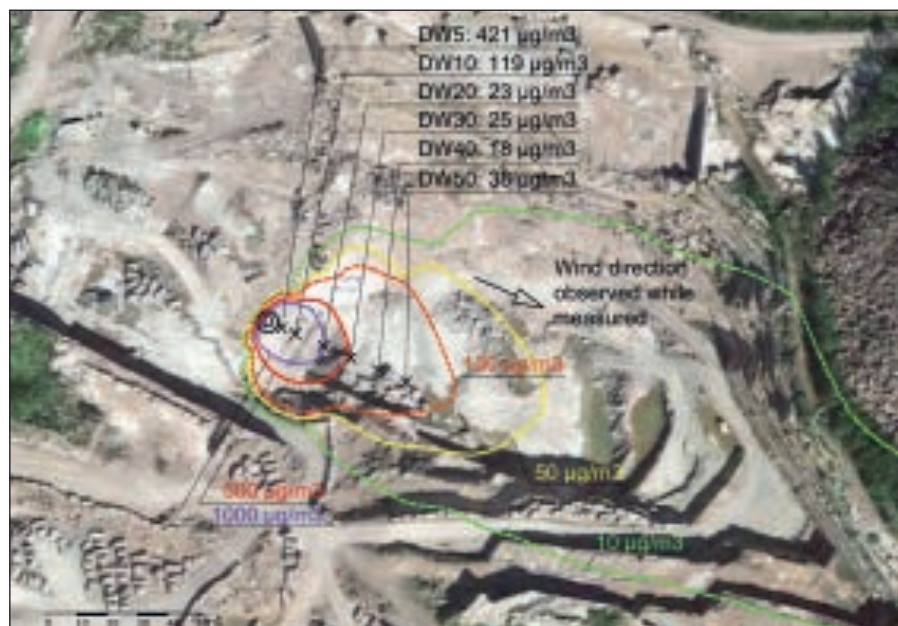
Kuva 6. Pölymallinnuksen tulokset luonnonkivilouhimolla. Mallinnuksessa käytetty päästökerroin on julkaisusta Aatos 2003.
